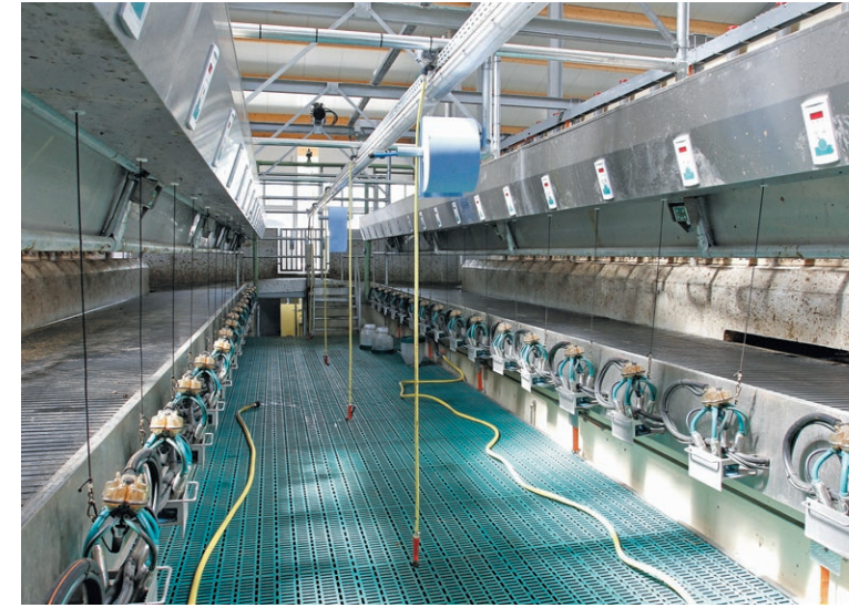
In de 2 x 20-stands zij-aan-zij melkstal van GEA kunnen per uur 150 à 160 koeien worden gemolken. De maatschap Jonkman wil melkers inhuren. Daarom is de put uitgerust met een beweegbare vloer.
