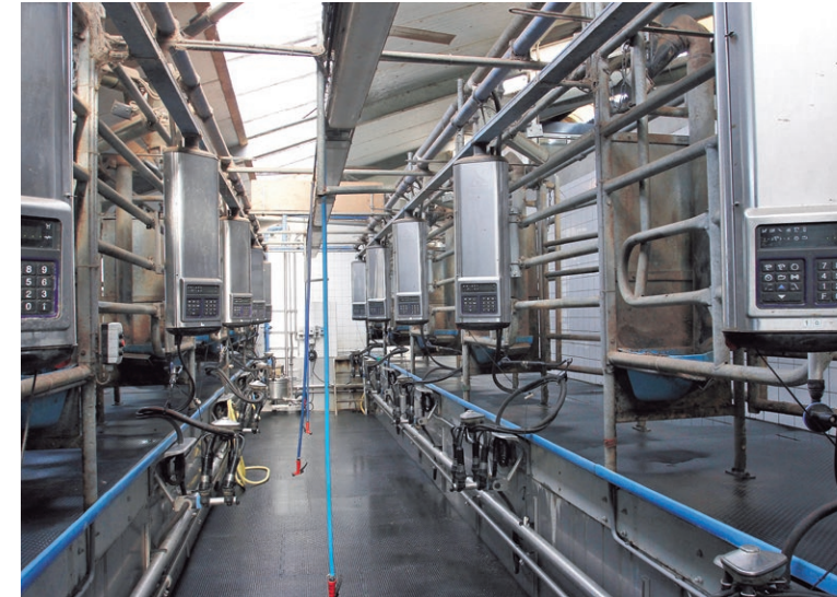
Na nog geen jaar automatisch te hebben gemolken, verruilde Slingerland de beide melkrobots in 2011 voor een 2 x 5-stands open tandem melkstal. „Sindsdien geniet ik weer met volle teugen”, aldus de veehouder.
